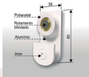
1122M Mini Carrinho Simples (Portas 20kg) Acabamento Branco ou Polido
