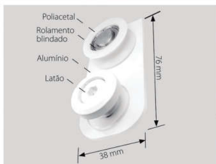
1120A Mini Carrinho Simples (Portas 20kg) Redondo Acabamento Branco ou Polido
